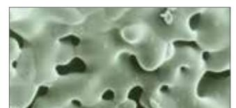
▲ REM-Vergrößerungen Abb. 3 und 4: Mikroporosität von BioBASE sichtbar; Mikroporosität im Detail: Porengröße bis ca. 5  $\mu$ m, Sinterhalse erkennbar
