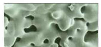
▲ REM-Vergrößerungen Abb. 3 und 4: Mikroporosität von BioBASE sichtbar; Mikroporosität im Detail: Porengröße bis ca. 5 \mu m, Sinterhalse erkennbar
