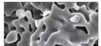
▲ REM-Vergrößerungen Abb. 1 und 2: Mikroporosität von BetaBASE sichtbar; Mikroporosität im Detail: Poren bis ca. 5 \mu m, Sinterhalse erkennbar
